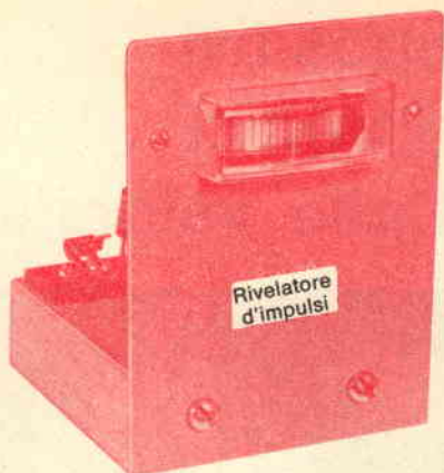
Fig. 3 - Il rivelatore dello stato di uscita usa uno strumento da pannello a zero centrale per il bilanciamento stereo.
